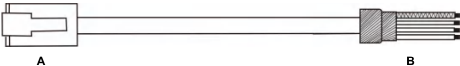
图4.9 伺服驱动器与PLC通讯线缆示意图
